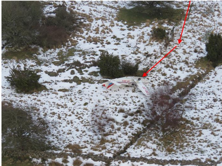
Figur 10. Slutlig position. De röda pilarna visar flygplanets färdriktning enligt spåren på marken.
