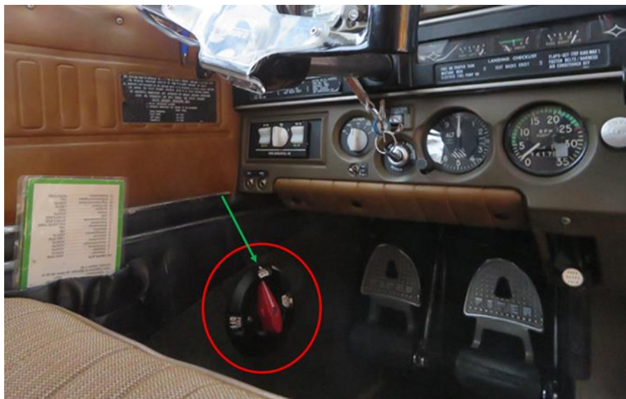
Figur 12. Tankväljaren efter händelsen. Tankväljaren står på position "L" vilket betyder att vänster tank var inkopplad. Foto: Räddningstjänsten.
