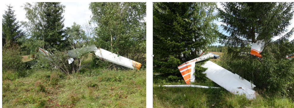
Figur 2. Flygplansvraket. Den vänstra bilden visar i färdriktningen flygplanets avbrutna flygkropp och höger vinge. Höger bild visar motsatt färdriktningen den avbrutna bakre delen av flygkroppen och vänster vinge med avbruten vingpets.
