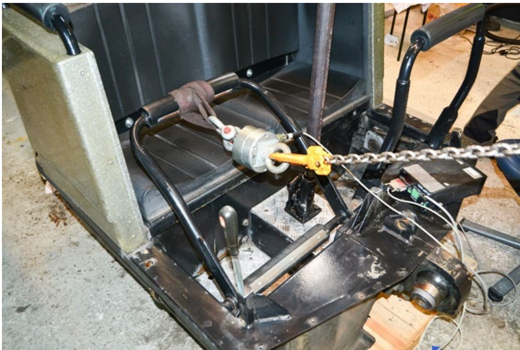
Figur 22. Riggning vid dragprov av en säkerhetsbygel.
