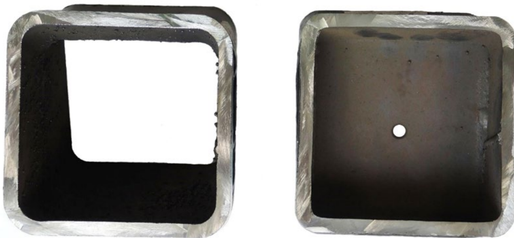
Figur 18. Tvärsnitt av två uppsågade bärarmar. Ursprunglig bärarm tillverkad 1986/87 till höger och tillverkad 2019 till vänster. Bild: Element Materials Technology AB.
