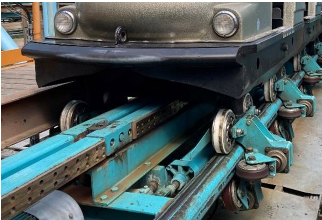
Figur 2. Främre delen av tåget med hjulboggierna med hjul ovan, under och på sidorna om rälsen. (Bilden är inte från olyckståget).
