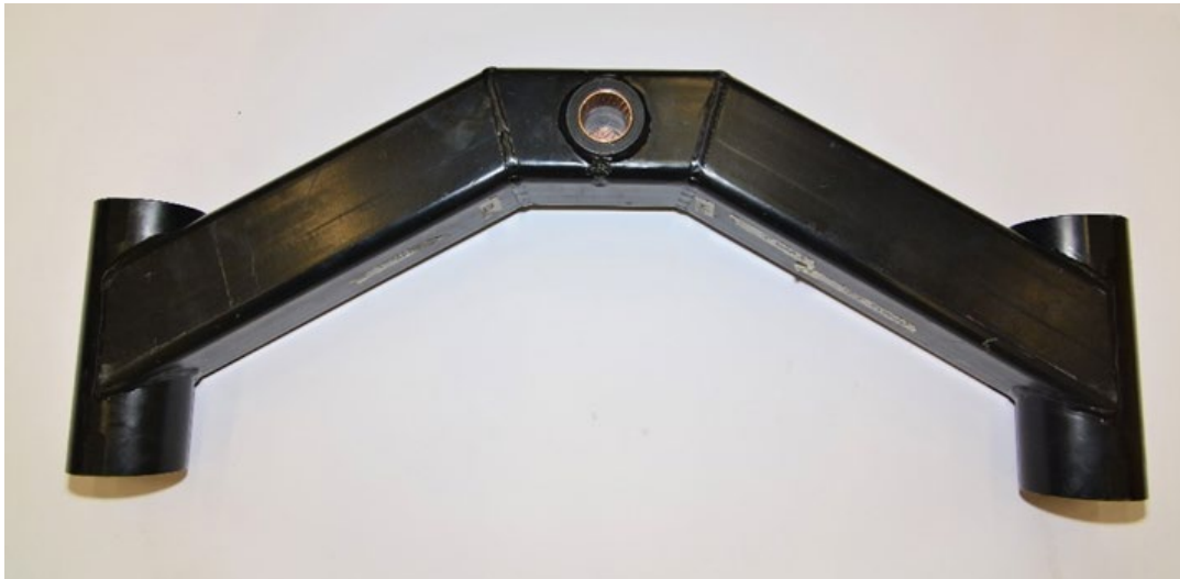
Figur 8. En främre bärlarm till ett Jetline-tåg med hålet för axelfästningen mot vagnen i mitten.
