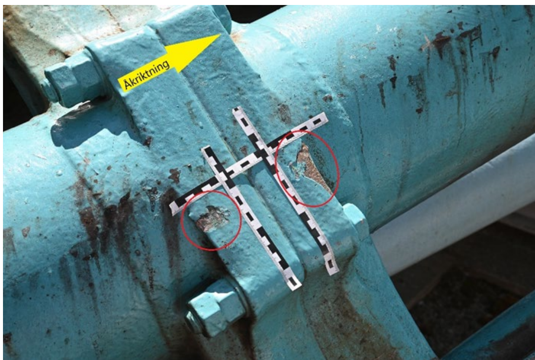
Figur 11. Första islagsmärket i banan. Röda markeringar inritade av SHK visar var islaget skett. Påförda svart-vita tejpmarkeringar gjorda av Polismyndigheten.
