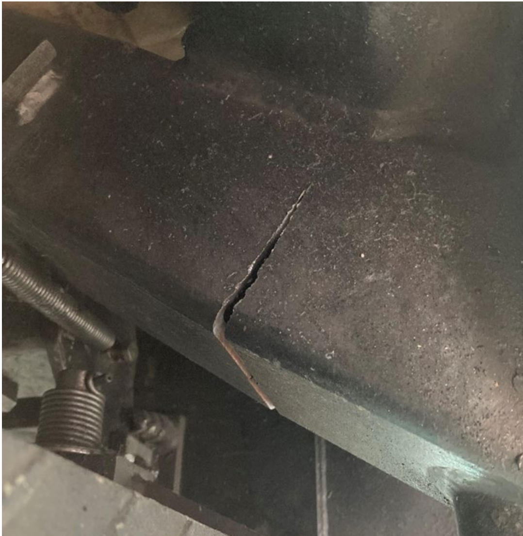
Figur 27. Sprickan som upptäcktes 28 augusti 2022 i en ursprunglig bakre bärmarm från 1988. Foto: Gröna Lund AB.
