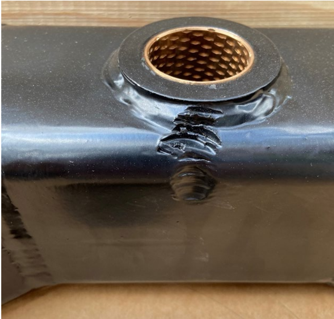
Figur 26. Skadorna som sannolikt uppkommit vid tillverkningen på en av de fem bärlarmar som levererades 2019.
