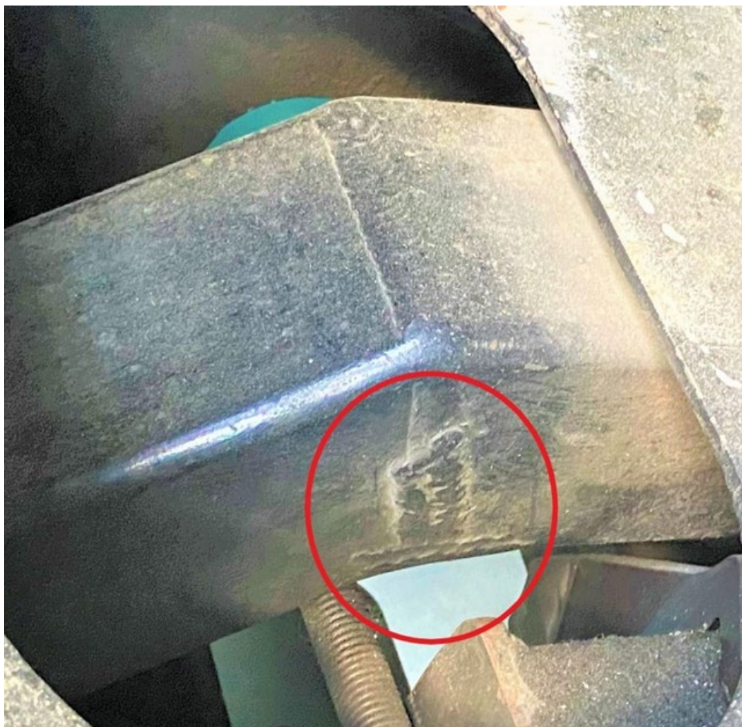
Figur 29. Svetsreparation på en bärrarm markerad med röd ring. Fotot är taget på en bärrarm monterad i C-tåget. Svetsreparationen är på svetsen mellan bärrarmens ytter- och mittdel.
